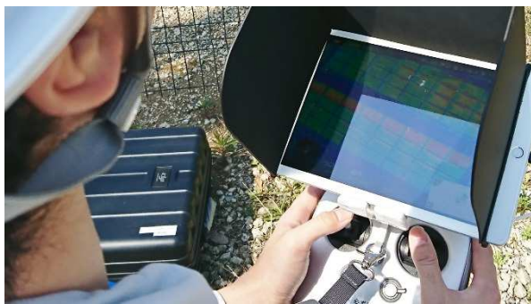
ドローン+サーモでストリングの高温部を確認
